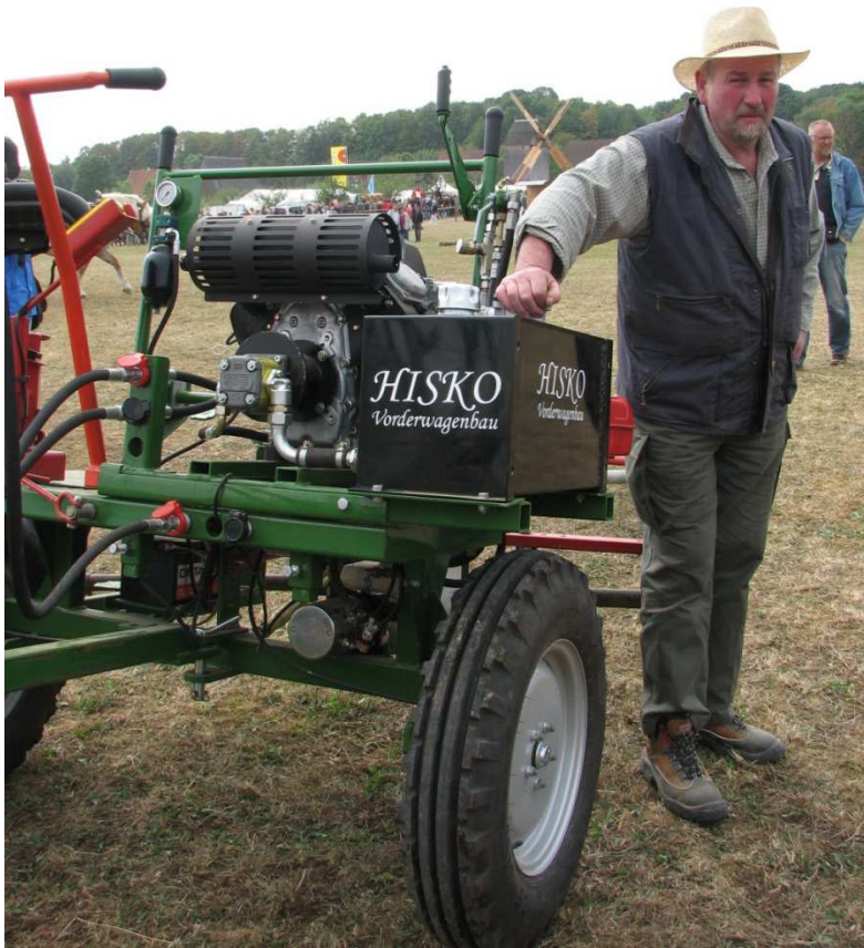
Vorderwagen mit abnehmbarem Benzin - Aufsatzmotor, Hersteller Briggs & Stratton, 2 Zylinder, 22 PS, luftgekühlt, Handstarter, Ausführung als Hydraulikaggregat, Hydraulikmotor mit Zapfwellenanschlußprofil
