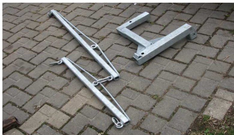
Bausatz zur Umrüstung des Vorderwagens auf dreispännigen Betrieb – verzinkte Ausführung
