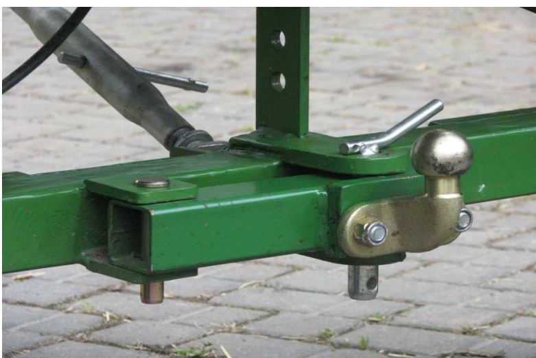
Wahlweise am Vorderwagen anbaubare Kugelkupplung – mit zwei Bolzen befestigt
