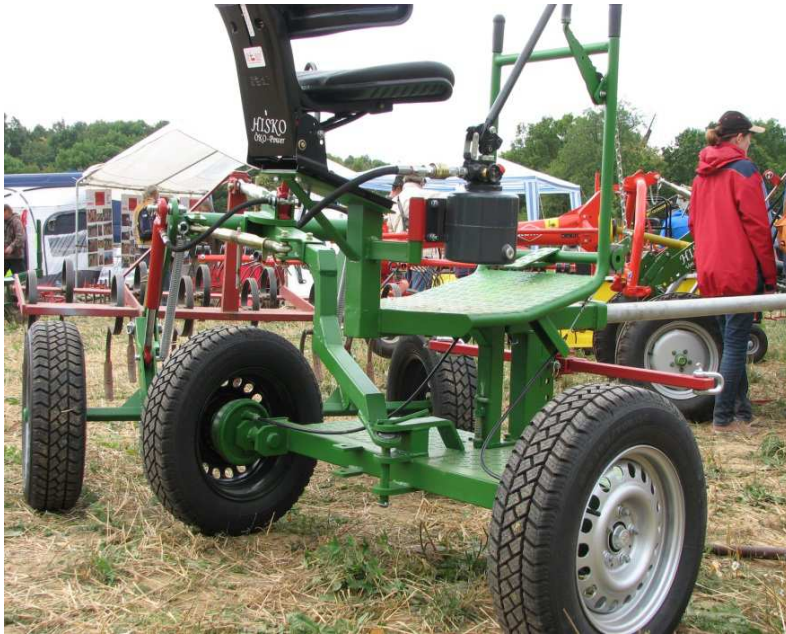
Handhydraulik mit Ölbehälter zur manuellen Bedienung des Krafthebers
