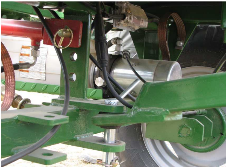
Elektrohydraulische Anlage zur Bedienung des Krafthebers, angebracht unterhalb der Fahrerplattform
